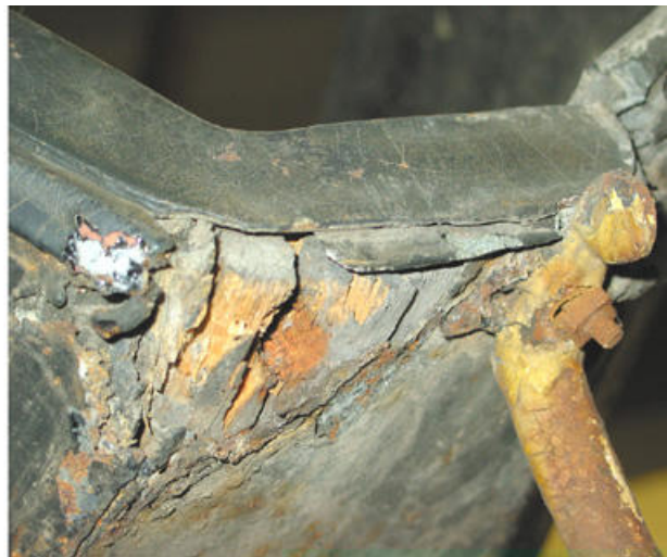
Abb. 68: Rechtseitige Ecke unterhalb der Trittpläche des Kutschbocks; nachträgliche Überarbeitungen am Holz (ausgetauscht) und am Karosserieblech. Auch die Versteifungswinkel sind nicht original. Vgl. Abb. 82, S. 73
