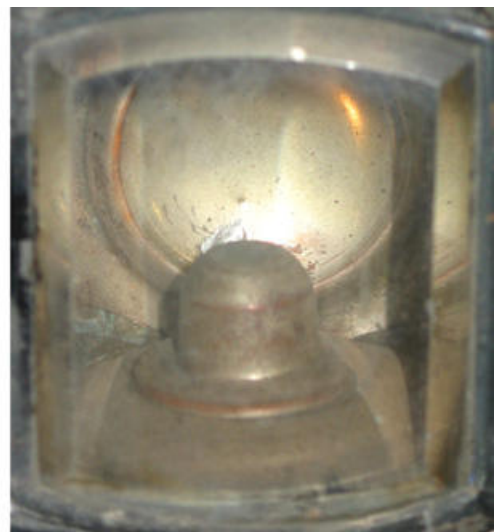
Abb. 62: Galvanisch vernickelter Laternenspiegel. Deutlich sichtbar die stellenweise durchscheinende Kupferleitschicht und punktuelle Beläge (Rost?).
