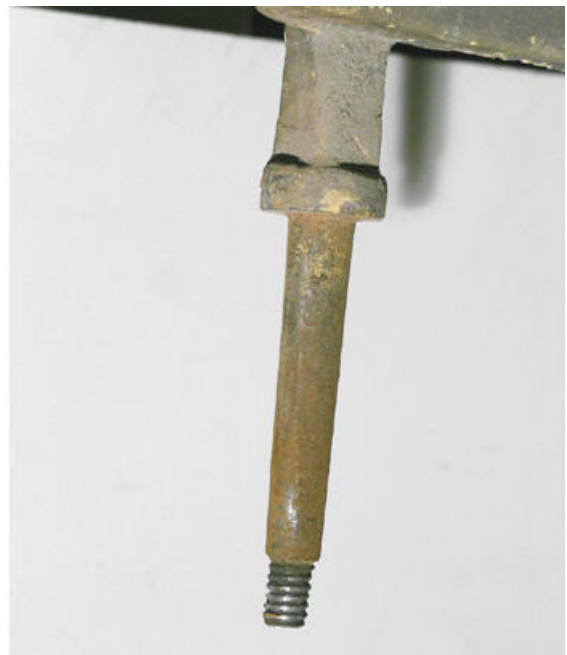
Abb. 49: Linke hintere Achse ohne Rad und Mutter. Man erkennt die konische Form, oben die Stoßscheibe und den vierkantigen Ansatz der Mittelachse.
