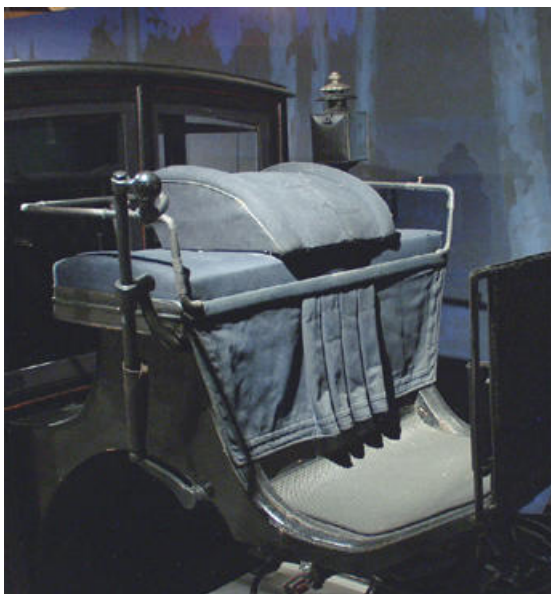
Abb. 92: Polsterung mit Draperie am Kutschbocks eines Coupés, bezeichnet Hofhandwerker, K. Marstall, Stuttgart, um 1890 (Museum für Kutschen – Chaisen – Karren, Heidenheim). Vgl. 14Abb. 10
