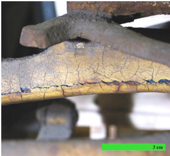
Abb. 86: Das vordere Federholz wird von unten durch ein Eisenband armiert; der Materialwechsel zeichnet sich deutlich durch Ausbrüche in der Lackierung ab.
