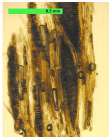
Abb. 108: Rotbuchenholz im Tangentialschnitt (Dünnschnitt-Probe H3-TS). Holzstrahlen in zwei verschiedenen Größen
