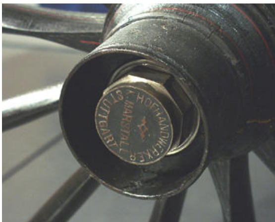
Abb. 23: Nabe und signierte Radnabenkappe eines Coupés um 1890, bezeichnet "Hofhandwerker, K. Marstall, Stuttgart" (Museum für Kutschen Chaisen Karren 27 , Heidenheim, vgl. Abb. 10)
