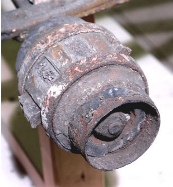
Abb. 80: Radnabe des rechten Vorderrades (nicht original), vgl. Abb. 51
