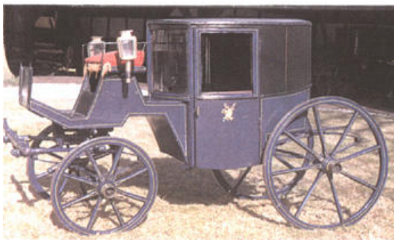
Abb. 17: Konstruktionsmodell eines Coupés Clarence, 1880-90, LxBxH 1,78x0,98x1,12m (Museum Achse, Rad und Wagen, Wiehl)
