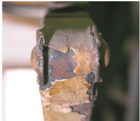
Abb. 45: Federgelenk der rechten hinteren Blattfeder; an den Federgelenken kam es an den Lackschichten besonders oft zu Ausbrüchen.
