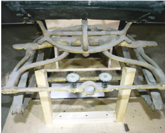
Abb. 41: Vorderachse mit Drehkranz, Blick von vorne
