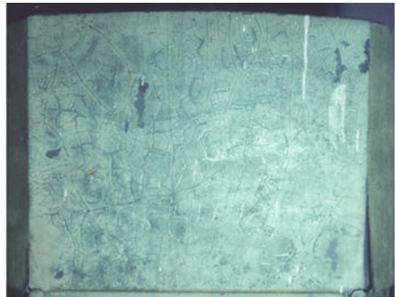
Abb. 53: Rückseite der Kutsche unter UV-Licht; der aufliegende Firnis besitzt eine gleichmäßig weißlich-gelbe Fluoreszenz.
