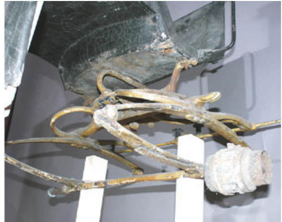
Abb. 42: Vorderachse mit Drehkranz, Blick von schräg unten hinten
